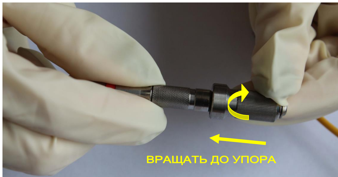
Рисунок 7. Установка заглушки оптического разъема проводника световодного магистрального.
