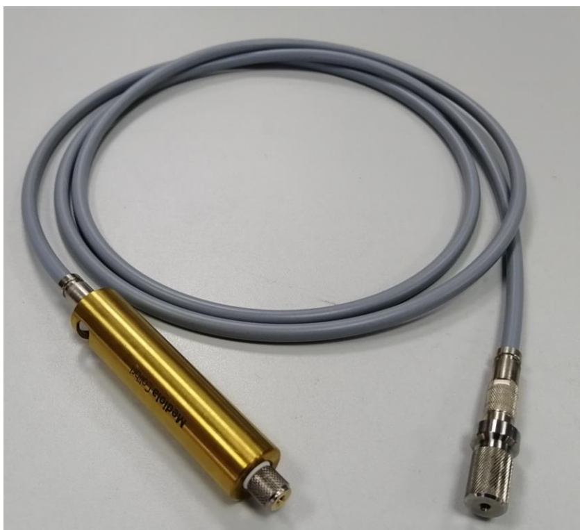
Рисунок 2. Держатель световода с проводником световодным магистральным, заглушки надеты.
