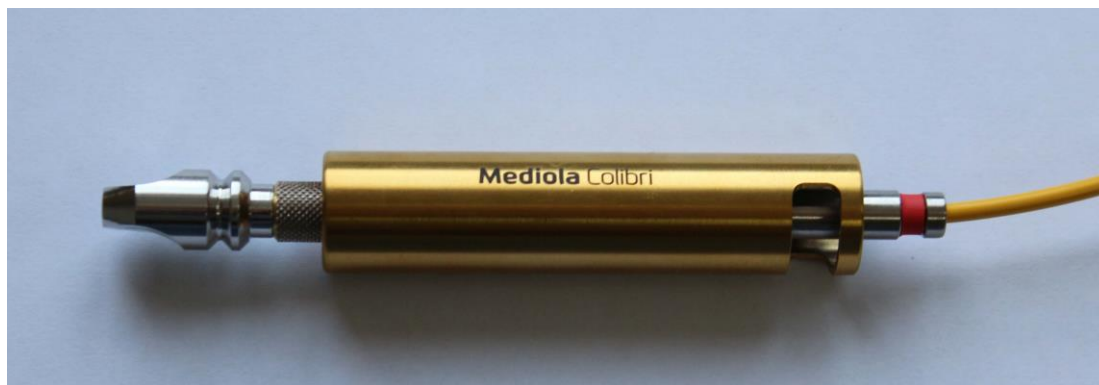
Рисунок 11. Держатель световода с установленным адаптером для контроля.
