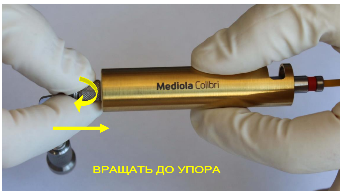
Рисунок 8. Установка заглушки оптического разъема держателя.
